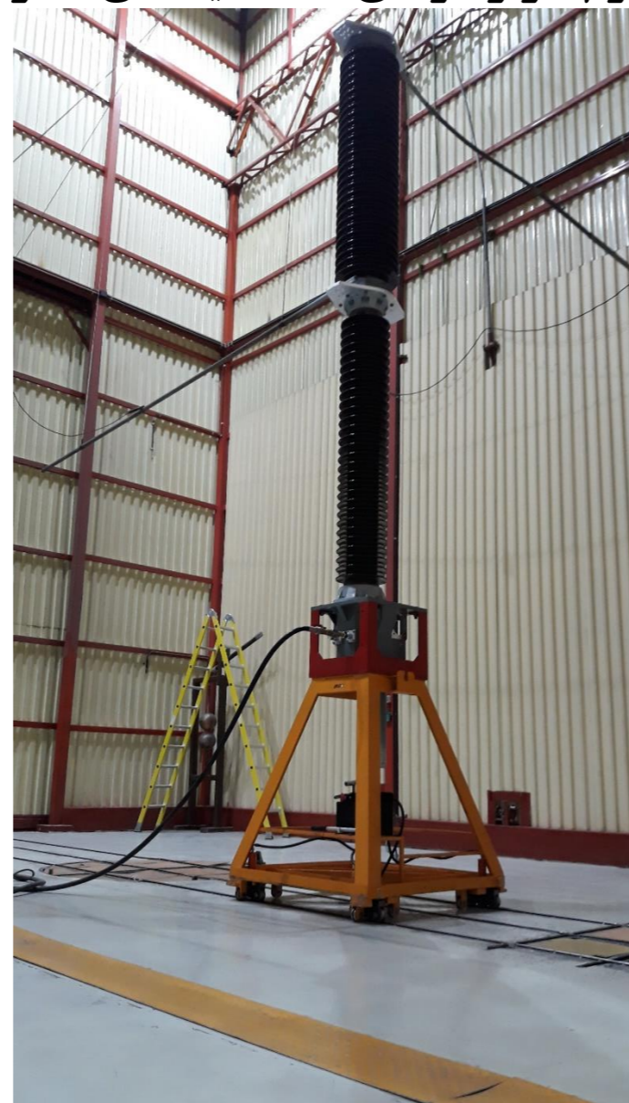
شکل ۲- یک کلید ۲۴۵ کیلوولت در حال انجام تست power frequency withstand voltage
