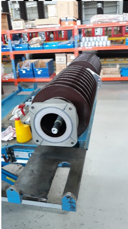
شکل ۴- یک پل (pole) در حال مونتاژ- انتهای میله عایقی که نیرو را از مکانیزم فرمان گرفته و جزئی از کنتاکت متحرک است را مشاهده می کنید.
